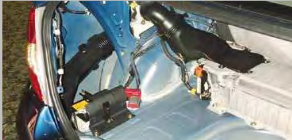
Bagage på hybridbil servicebrytare och batteripack.
